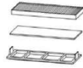
Szivacsos filter és hatékony szűrőszita
