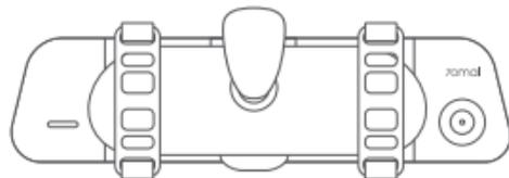
Megjegyzés: ha az eredeti visszapillantó tükör túl hosszú, a széthúzható testtel állítsa be a kamera pozícióját.
