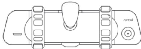
Примечание. Если зеркало заднего вида слишком длинное, отрегулируйте положение камеры, с помощью телескопического корпуса.
